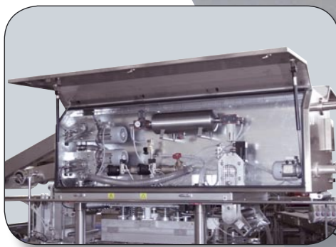
Circuito vuoto e gas. Vac and Gas delivery system. Intérieur du carter, côté moteurs bobines et circuit de vide. Vakuum- und Begasungssystem. Circuito vacío y gas.
